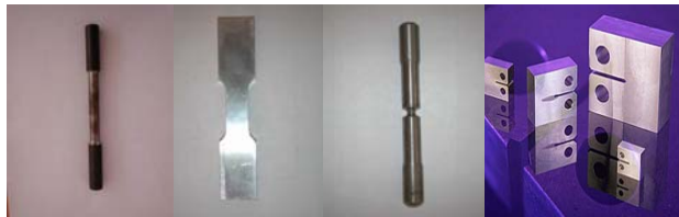
Eprouvettes de traction cylindriques, plates parallélogramiques, axisymétriques entaillées, entaillées pré-fissurées
