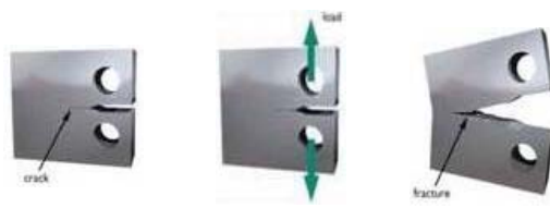
Essai de traction sur des éprouvettes entaillées pré-fissurées
